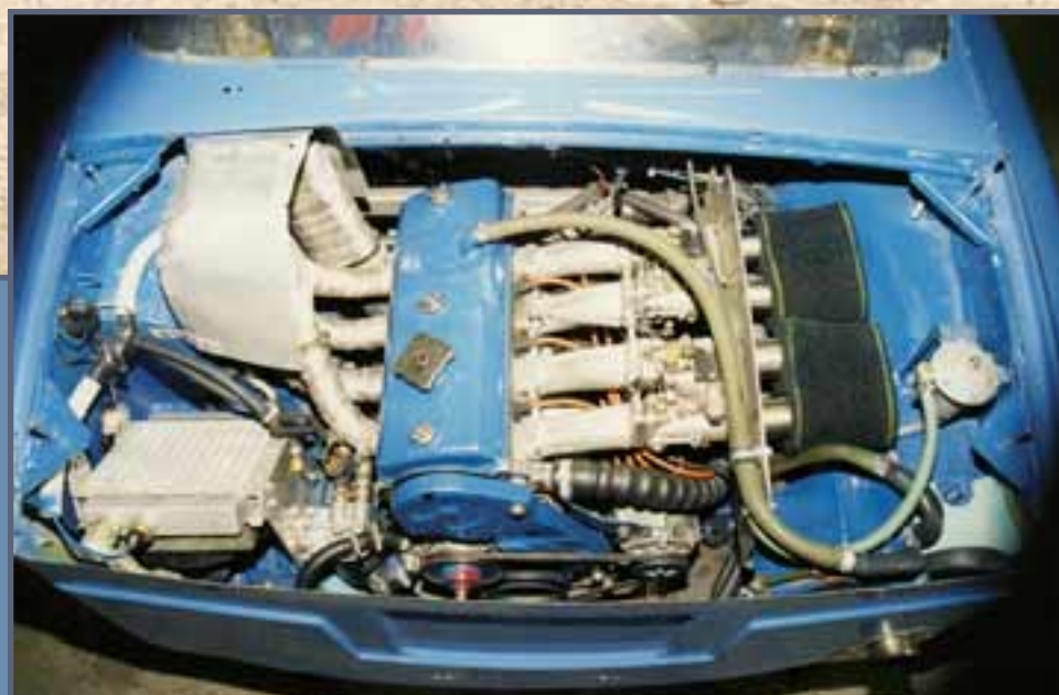
Täältä löytyy se liikkeellepaneva voima. Kone on aloittanut joskus taipaleensa R25:n nokalla. Pakosarjan muoto on tilanpuutteen vuoksi todella mielenkiintoinen. Ruokinnasta huolehtii kaksi 48mm:n tupla-Dellortoa. Tehoa mitattu tässä asussa 210 hv ja vääntöä 250 Nm.
