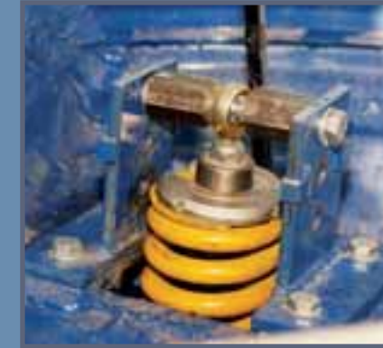
Yksityiskohta tekniikasta: taka-akselin ripustusta entisen hattuhyllyn paikalla. Yksinkertaista mutta ilmeisen toimivaa.
