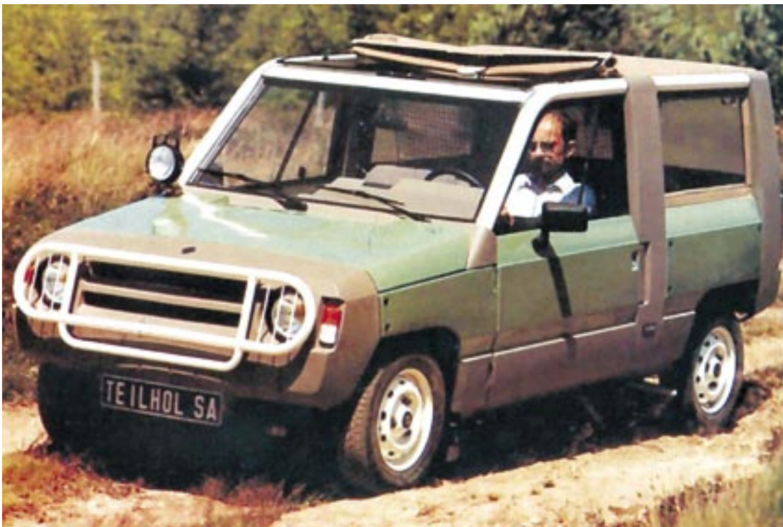
Kuvassa Rodéo 5 vihreästä väristä tunnistettavana Sologne 4x4 -nelivetversio vuodelta 1984. Sinparin valmistaman nelivetotekniikan sai tilattua myös Rodéo 4 ja Rodéo 6 -malleihin.
